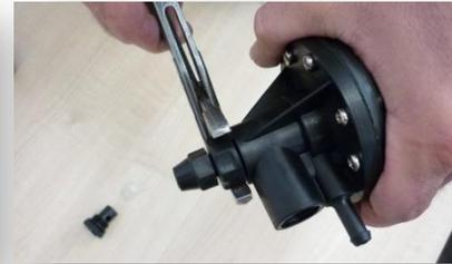
*Svitare la vite posteriore del dosatore*
